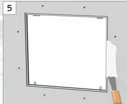
Potom je neophodno izvršiti test funkcionalnosti proizvoda (otvoriti, skinuti vratanca, vratiti ih, zatvoriti).
