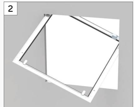
Pozicionirati pravilno ram uz poštovanje idealne horizontalnosti i vertikalnosti stranica, potom privremeno fiksirajte položaj rama otvora stegom i obeležite mesta za primenu vijaka. Osovinski razmak vijaka bi trebao biti  $\leq 200$  mm. U slučaju da je model revizionog otvora koji sprečava prenos vazduha i prašine, razmak rupa bi trebao biti  $\leq 100$  mm.
