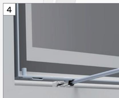
Zašrafite prethodno poravnati i za okvir fiksirani ram kroz postojeće bočne otvore za ovu namenu (preporuka Nida Metal Vijak za profile 212x55). Proverite ponovo pravougaonost rama i kao i da tokom eventualnog prenatrženog fiksiranja nije došlo do minimalne deformacije stranica.
