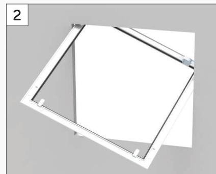
Pozicionirati pravilno ram uz poštovanje idealnog ugla od 90 stepeni izmedju stranica, potom privremeno fiksirajte položaj rama otvora stegom i obeležite mesta za primenu vijaka. Osovinski razmak vijaka bi trebao biti  $\leq 200$  mm. U slučaju da je model revizionog otvora koji sprečava prenos vazduha i prašine, razmak rupa bi trebao biti  $\leq 100$  mm.
