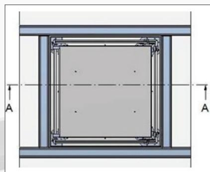
Ukoliko proizvod sadrži i gornji zaštitni deo, ne zaboraviti njegovu montažu. Prenos njegove težine treba izvršiti na perimetarne CD profile u skladu sa detaljem poprečnog preseka A-A.
