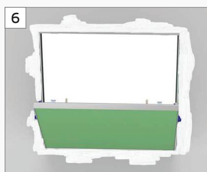
U slučaju da revizionni otvor čini opterećenje plafona veće od 7kg/m2, ne zaboraviti da je neophodna ugradnja perimetarnog ojačanja od suvomontažnih profila sa razmakom od oko 5 mm do rama proizvoda.
