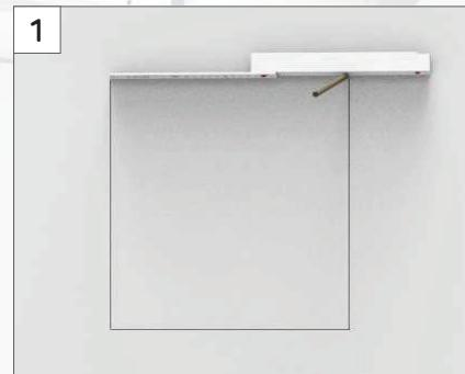
Odvojite vratanca od rama, koji potom dijagonalno provucite kroz isečeni otvor i onda da sa pozadine pozicionirajte na sam otvor.
