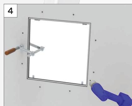
Šupljinu izmedju rama i obodne gips kartonske ploče na zidu popuniti ispunom za spojeve. Po sušenju očistite stranice rama od ostataka ispune i drugih nečistoća nastalih tokom ugradnje.
