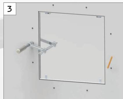
Najpre izbušite rupe bišilicom i burgijom prečnika 3mm i potom primenite vijke i zaštitne kapice koje su došle zajedno u setu.
