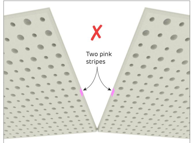
**FIGURE 18 Incorrect Short Edge Orientation**
