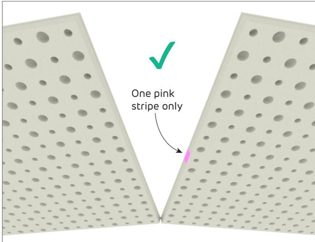
**FIGURE 17 Correct Short Edge Orientation**
