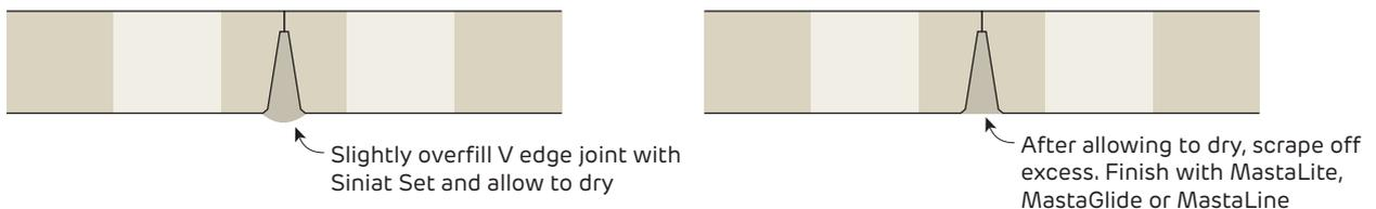
**FIGURE 21 V Edge Jointing**
